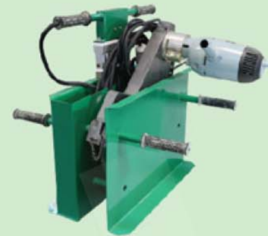
เครื่องให้ความร้อน/ เครื่องปาดปลายท่อ Heating Machine/ Electric Milling Cutter
